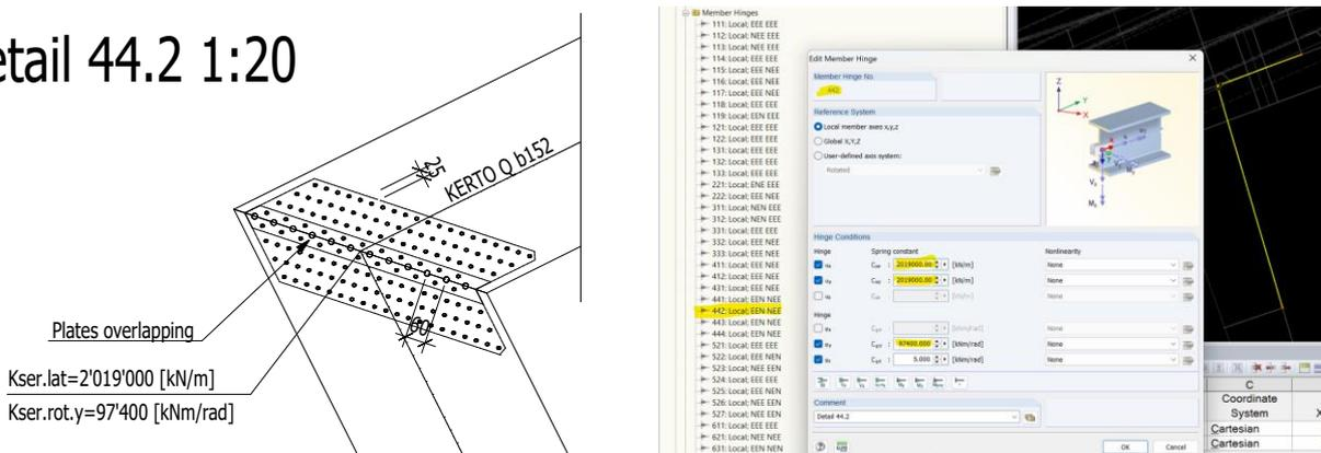
Figure 10. Consistent modelling: Detail Nr. 44.2 correspond hinge 442. ©sblumer
